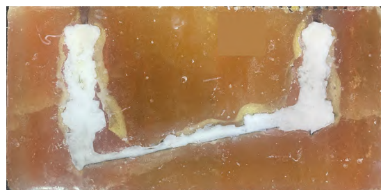
(a) 5号实验(排量 1 mL/min)
