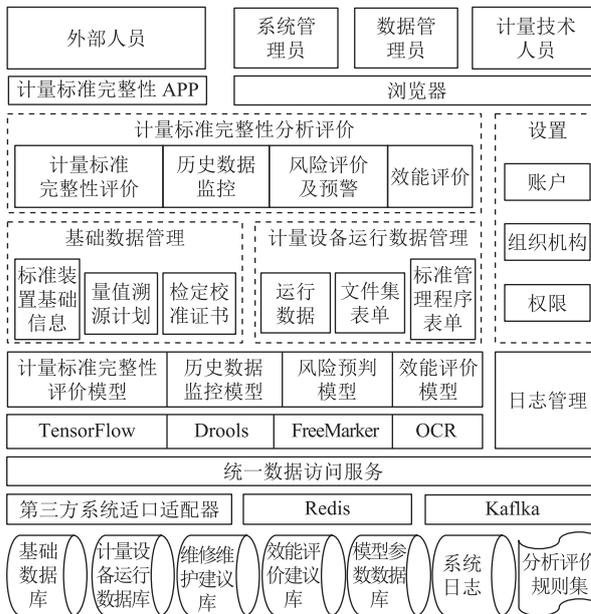
图3 天然气计量标准装置完整性质量控制系统平台架构图
