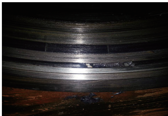
(a) 软密封损伤严重
