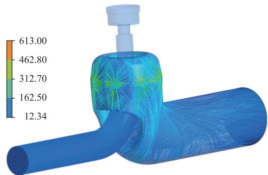
图5 节流过程减压阀内流体速度流线图(m/s)
