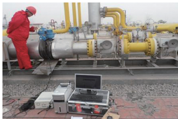
图 16 唐山分输站温降现场测试
