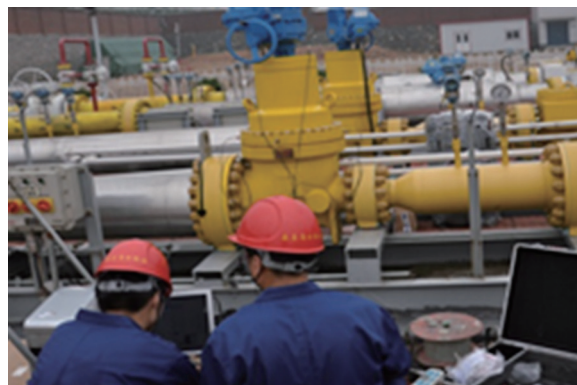
图 15 秦皇岛分输站温降现场测试
