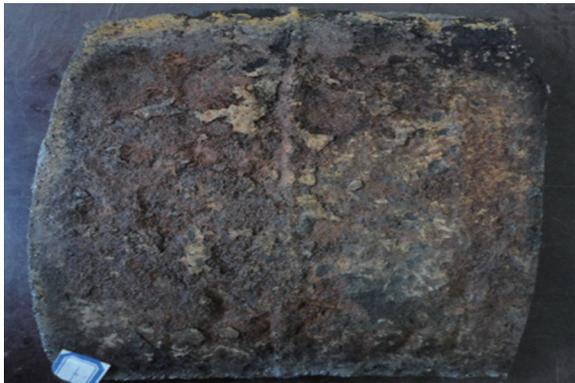
图 2 X60 钢管道现场腐蚀宏观形貌
