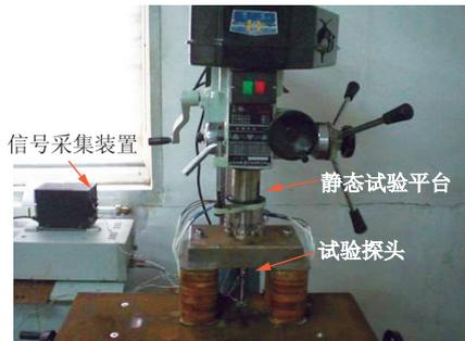
图2 管道漏磁检测三维探头静态试验装置
