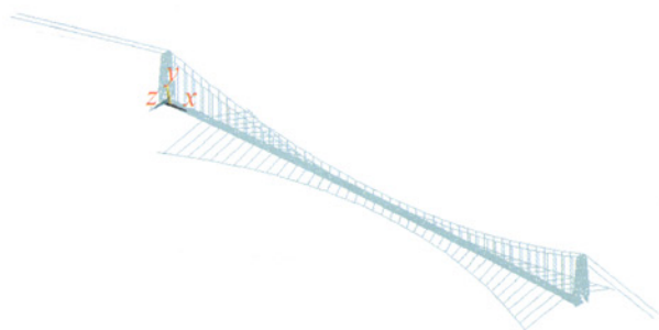
图 1 悬索式管桥的有限元整体模型
